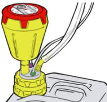
6. Drücken Sie den Knopf auf dem b.safe Abluftfilter, um die Wechselanzeige zu aktivieren. Optional: Notieren Sie das Wechseldatum auf dem Etikett.
