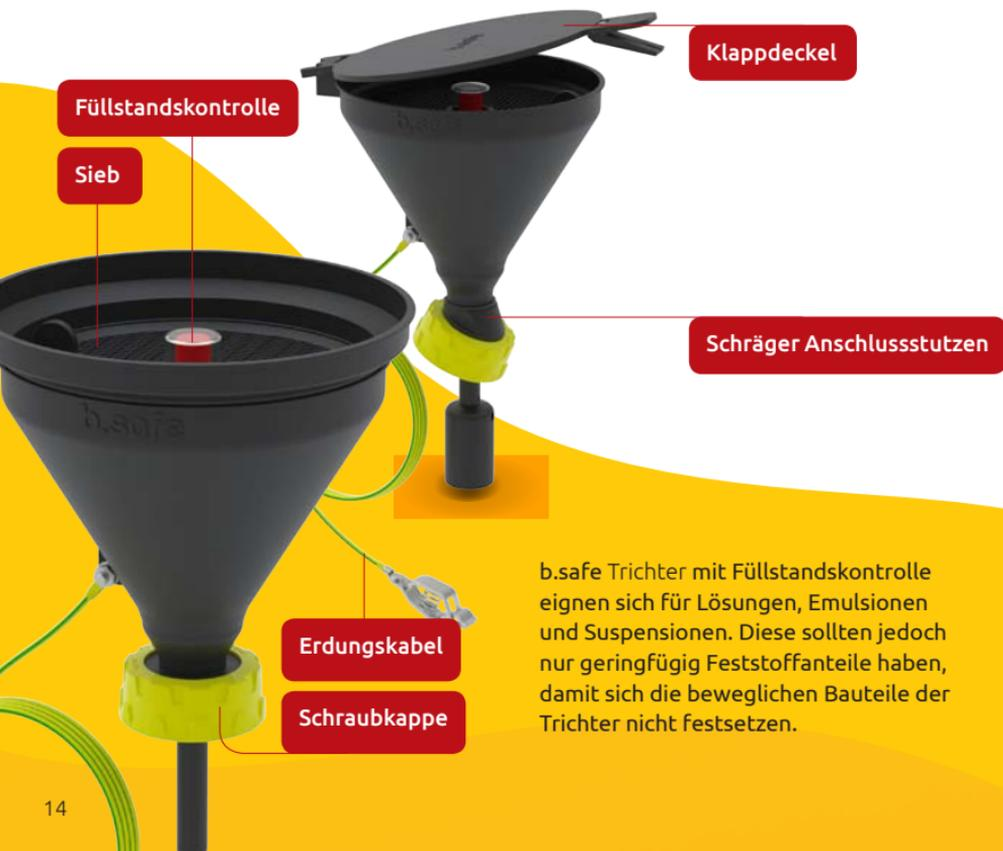
b.safe Trichter mit Füllstandskontrolle eignen sich für Lösungen, Emulsionen und Suspensionen. Diese sollten jedoch nur geringfügig Feststoffanteile haben, damit sich die beweglichen Bauteile der Trichter nicht festsetzen.
