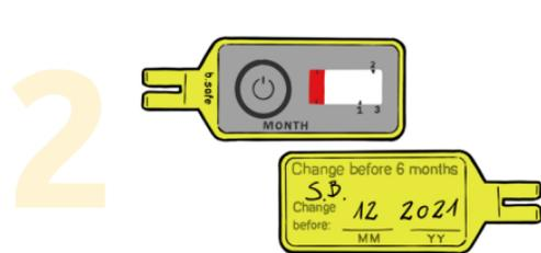
Drücken Sie den Knopf am b.safe Timestrip, um die Wechselanzeige für das b.safe Belüftungsventil zu aktivieren.
