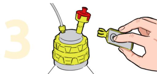
Stecken Sie den b.safe Timestrip an den Ring des b.safe Belüftungsventils.
