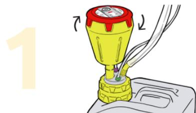
Schrauben Sie einen b.safe Abluftfilter in das freie Gewinde der b.safe Waste Cap.
