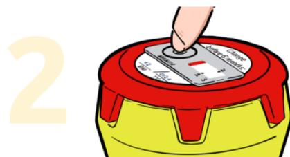
Drücken Sie den Knopf auf dem b.safe Abluftfilter, um die Wechselanzeige zu aktivieren. Optional: Notieren Sie das Wechseldatum auf dem Etikett.
