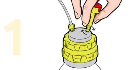
Schrauben Sie das b.safe Belüftungsventil in die b.safe Cap.
